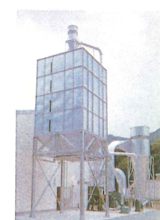
サイクロン集塵装置・ ファン45KW・集塵室50m 3
